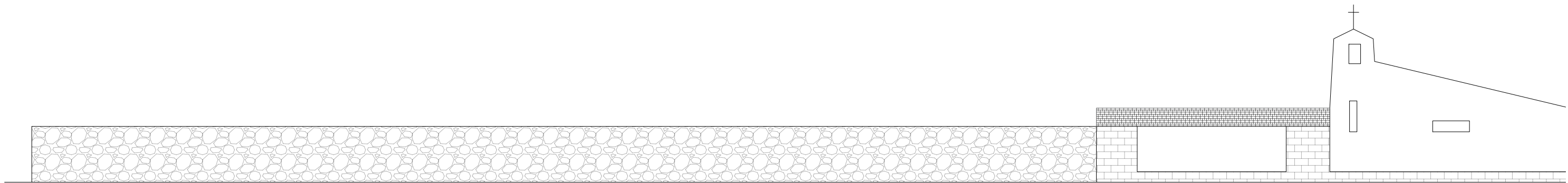
CERRAMIENTO CEMENTERIO ANTIGUO_ Mampostería de piedra
