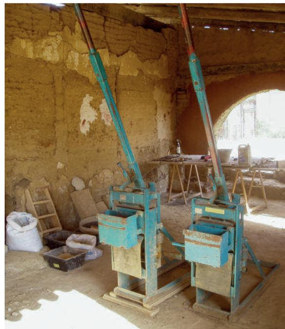
*Fabricación de BTC en Amayuelas de Arriba (Palencia) mediante prensa mecánica (izquierda) y prensa manual (derecha). Fuente: el autor (izquierda); Jové, F. (derecha)*
